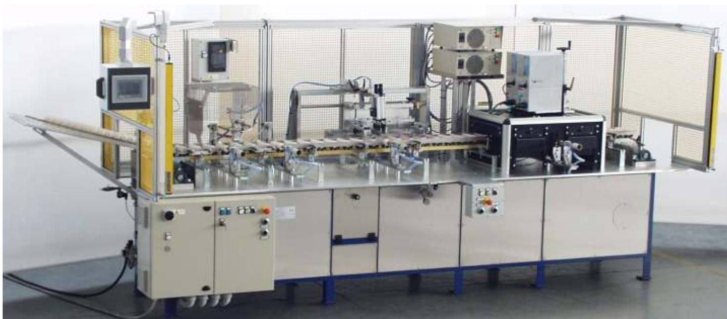
MACCHINA AUTOMATICA PER LA STAMPA A REGISTRO DI FLACONI CILINDRICI
